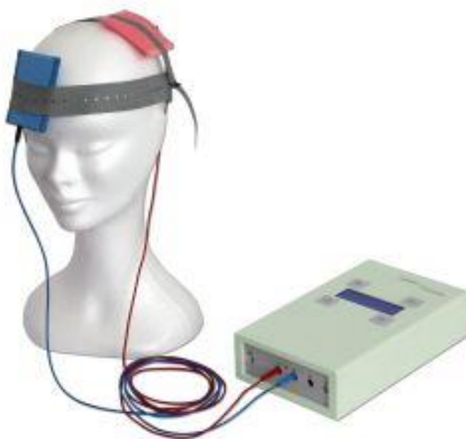
FIGURA 4 – Esquema Frontal da colocação aproximada dos Eletrodos.
