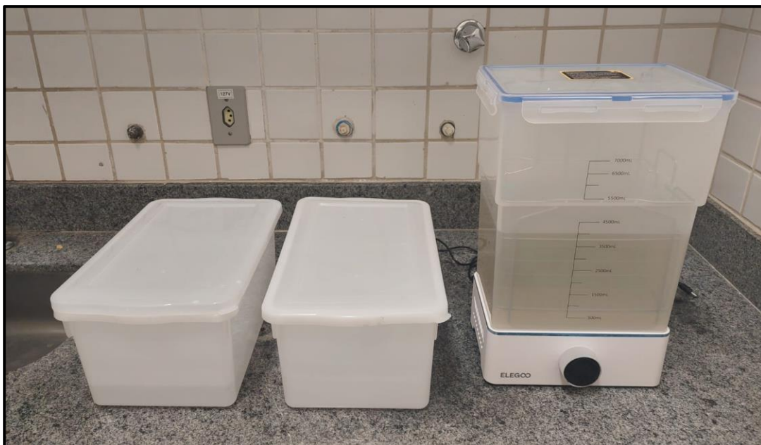
Figura 7: Locais para a lavagem dos modelos - caixas apropriadas contendo álcool etílico para lavagem manual sequencial e lavadora automática contendo álcool isopropílico.
