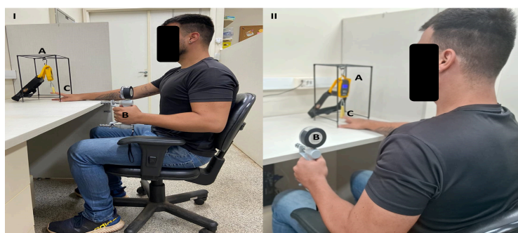
Fig 2. Figura representativa do posicionamento do paciente e do sistema desenvolvido para avaliar o overflow neste trabalho. I e II - O sujeito está sentado com o tronco alinhado, pés e braços apoiados e cotovelo a 90° com a mão livre para realizar a preensão do teste. (A) Dinamômetro de dedo/carga. (B) Dinamômetro de mão. Dedo indicador realizando contração isométrica resistida contra uma célula de carga (C).
