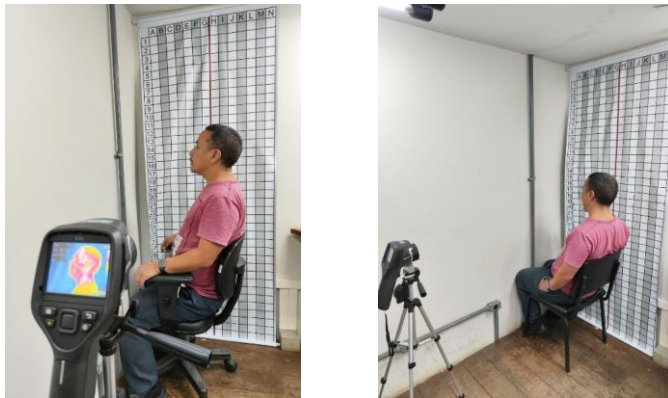
Figura 2: Cenário de captura das imagens termográficas com distância de 1 metro entre a câmera e o pé da cadeira.
